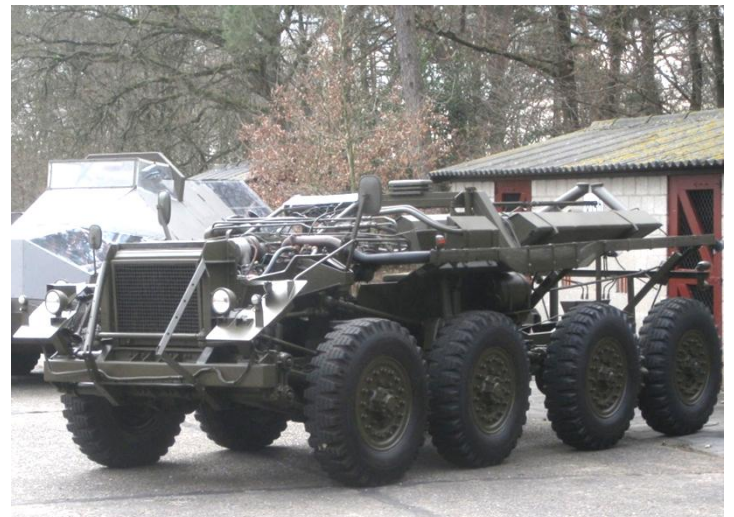
Die opengewerkte YP408 is bij 310 Hrscie geheel ontroest en gespoten en daarna gerestaureerd bij de SRCTT werkplaats in Nieuw Milligen. Zo komt dit voormalige instructiemodel van het OCTD als aanwinst in 2013 rijdend binnen bij de SRCTT collectie in Soesterberg.
