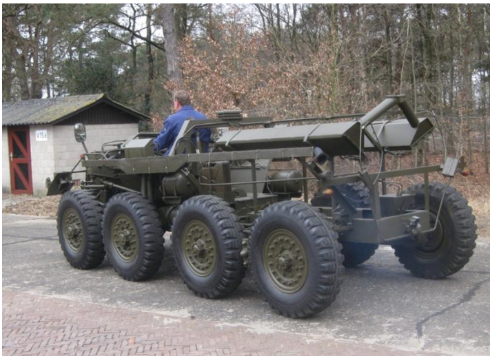
Die opengewerkte YP408 is bij 310 Hrscie geheel ontroest en gespoten en daarna gerestaureerd bij de SRCTT werkplaats in Nieuw Milligen. Zo komt dit voormalige instructiemodel van het OCTD als aanwinst in 2013 rijdend binnen bij de SRCTT collectie in Soesterberg.
