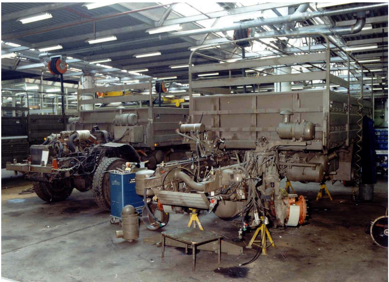
Groot (4 e / 5 e echelons) onderhoud aan diverse wielvoertuigen in de hal van de MCW, locatie Utrecht (voormalig 575 TD Centrale werkplaats).
